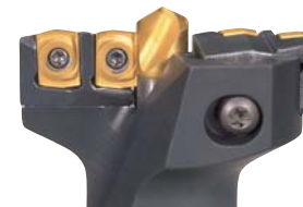
Установите внутреннюю пластину во внутреннюю вставку.
