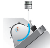
Проверка динамических ошибок станка
